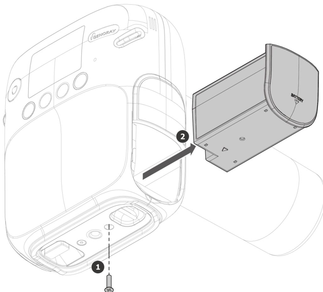
1. С помощью отвертки (+) снимите крепежные болты аккумулятора (1 шт.) с нижней части оборудования.
